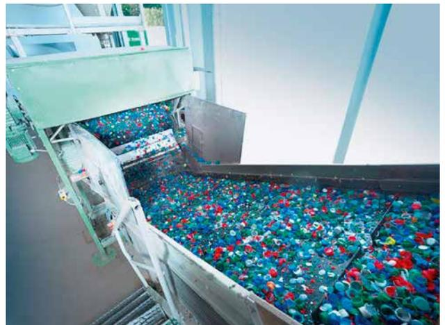
*Alte Flaschenverschlüsse am laufenden Band: AFG-Recycling in Neuwied verarbeitet sie zu Hightech-Mahlgut – eine Zwischenstufe in der Kreislaufwirtschaft für Kunststoffe*
